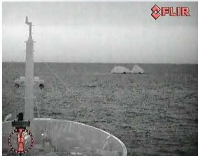
Прожектор только освещает предметы узкой полосой света. Тепловизионная камера обеспечивает более широкий угол обзора и лучшую ситуационную осведомленность.
