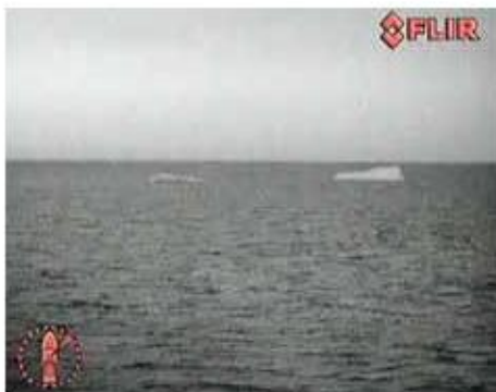
Крупные несяки отклоняют сигналы радара от антенны, но четко видны на тепловом изображении.
